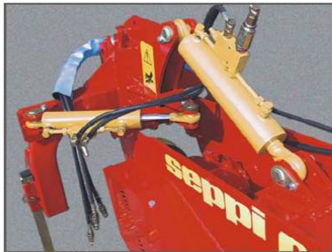
Posibilitate de pendulare laterala prin actionare hidraulica
