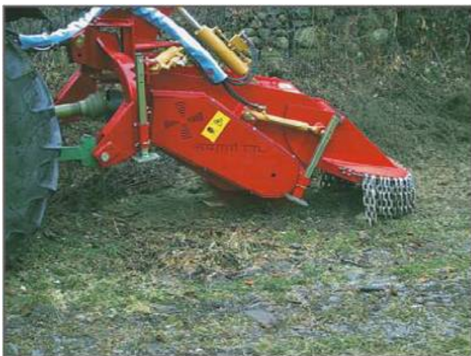
Deschidere hidraulica a placii posterioare pentru o mai buna apropiere de cioata
