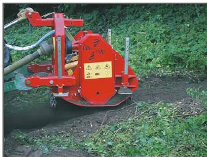
Frezarea cioatelor sub nivelul solului
